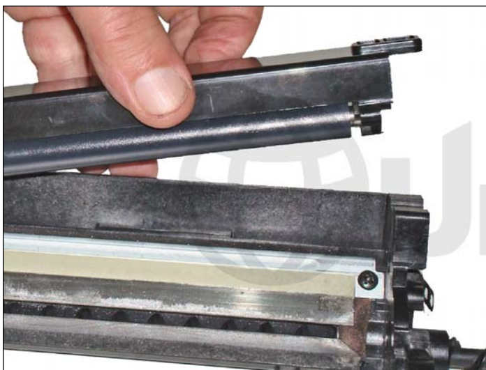
15. Acceso al PCR/Rodillo y Cuchilla de limpieza.
