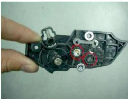
6. На правой боковой крышке контактные отверстия и ось фотобарабана очистить и смазать токопроводящей смазкой
