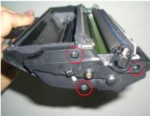
20. Закрутить пять винтов и засыпать через горловину тонер, после чего заглушить горловину пробкой. Обдуть картридж сжатым воздухом от пыли и остатков тонера. В случае необходимости протереть корпус картриджа ветошью, стараясь не повредить поверхность фотобарабана.
