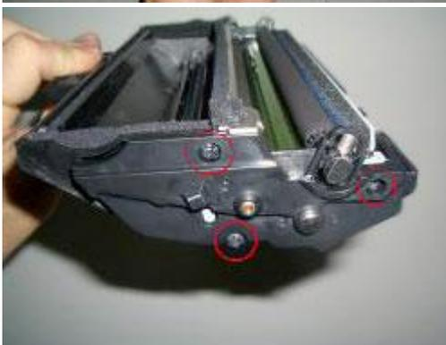
4. Повернуть картридж левой стороной на себя. Выкрутить три винта и снять левую боковую панель картриджа
