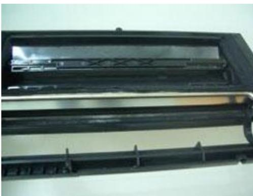
14. Установите ролик проявки и боковой стабилизатор на место.
