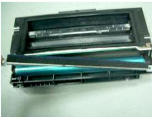
10. Удалить из картриджа фотобарабан, удерживая его за косозубые шестерни. Очистить картридж сжатым воздухом от остатков тонера.
