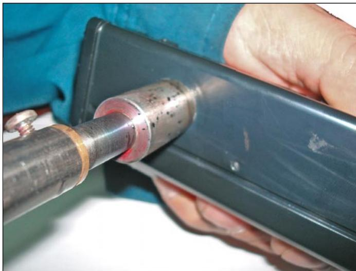
2. Aplicar el calor en el plano superior izquierdo sin presionar muy fuerte en la medida que vaya penetrando.
