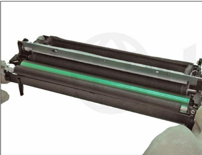
6. Desmontar el PCR moviendo los dos porta ejes hacia el frente.
