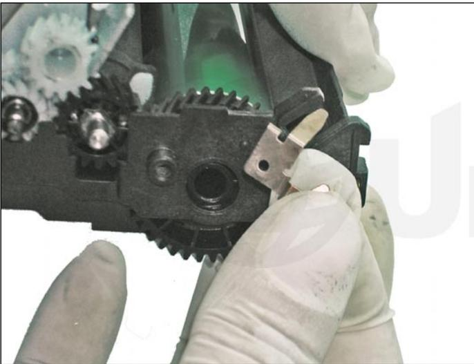
12. Desmontar el contacto del PCR.
