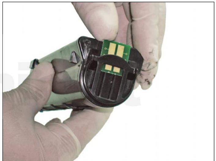
9. Deslizar el chip hasta hacer tope dentro de la ranura.
