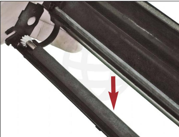
15. Limpiar el rodillo con aspiradora sin desmontarlo.
