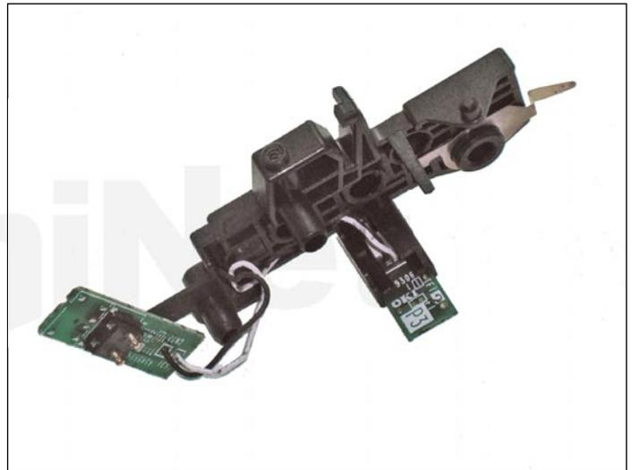
10. Desacoplar la sección de contacto del cartucho de tóner y de la unidad de imagen.
