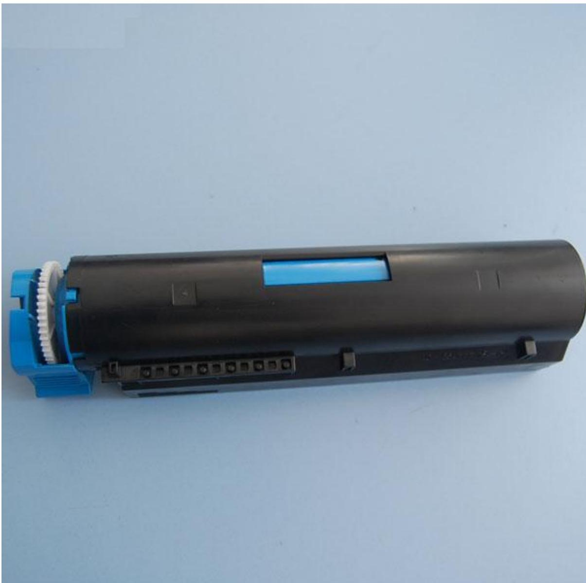
Технически тонер-картридж OKI 44992404 не разбирается и представляет собой просто тубу. Туба содержит механизм подкачки тонера и чип. В новой платформе V400 использованный тонер, теперь попадает по специальному каналу в бункер расположенный в драм-картридже. Это позволило значительно повысить ресурс драм-картриджа и стабилизировать качество печати.
