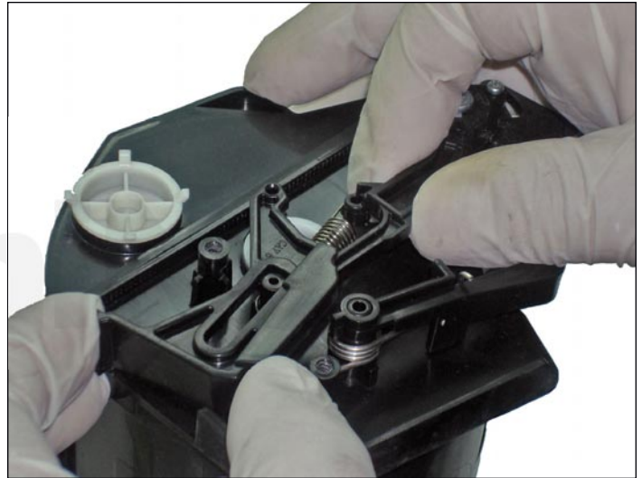
13. Montar la tecla en la guía y hacer que el extremo del brazo entre en el hueco de esta.
