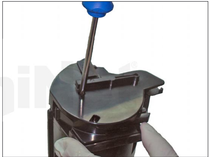
17. Fijar la tapa lateral con los tres tornillos Phillips.
