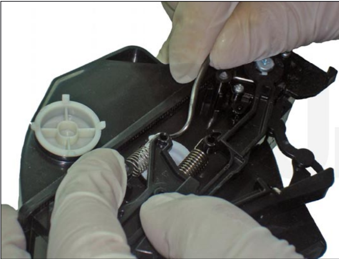
14. Posicionar el resorte de la tecla, enganchar una punta en el poste fijo del cartucho y la otra en el extremo superior de la tecla.
