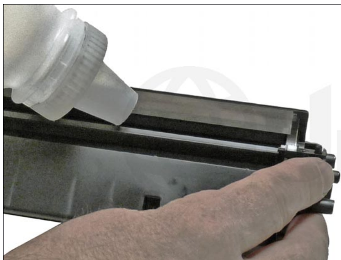
18. Засыпьте в бункер тонер для принтера HP P1102.
