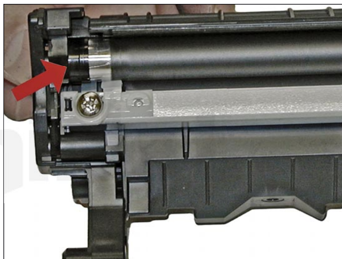
22. Установите магнитный вал, сначала ставится сторона с черным бушингом. Поверните вал до правильного положения направляющих.
