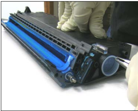
33. Remove the Toner fill plug.
