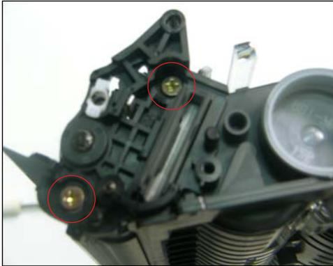
**REMOVING THE DEVELOPER ROLLER**
