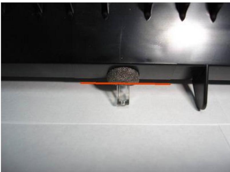
**Заклеиваем скотчем образовавшееся отверстие, чтобы предотвратить высыпание отработанного тонера из фотокондуктора.**
