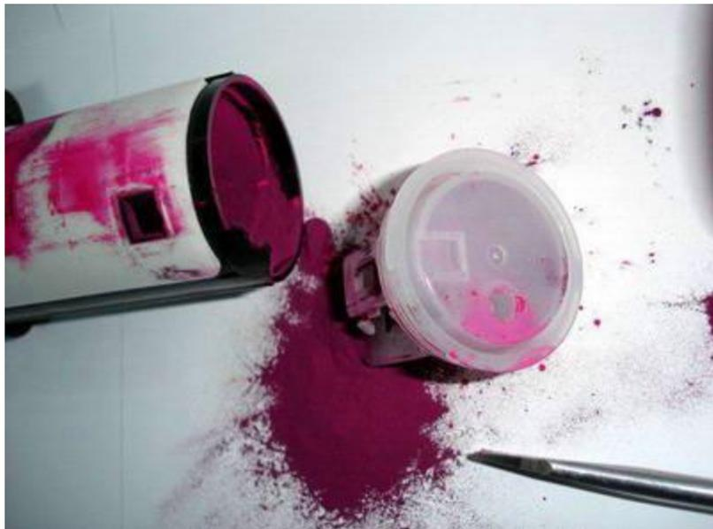
**Вытряхиваем отработку. Между отсеком для тонера и отсеком для отработки находится крышка. Чтобы удалить крышку между отсеками можно воспользоваться плоскогубцами.**
