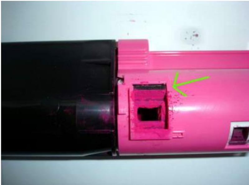
**Прикладываем дополнительное усилие и ступор уйдет под крышку - это позволит снять крышку с отсека с отработкой.**
