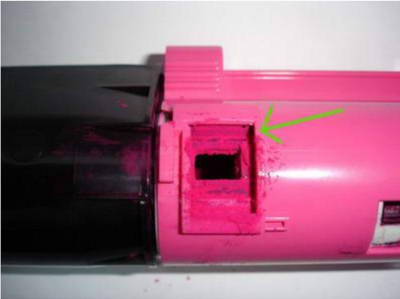
**Стаскиваем крышку с отсека с отработкой.**
