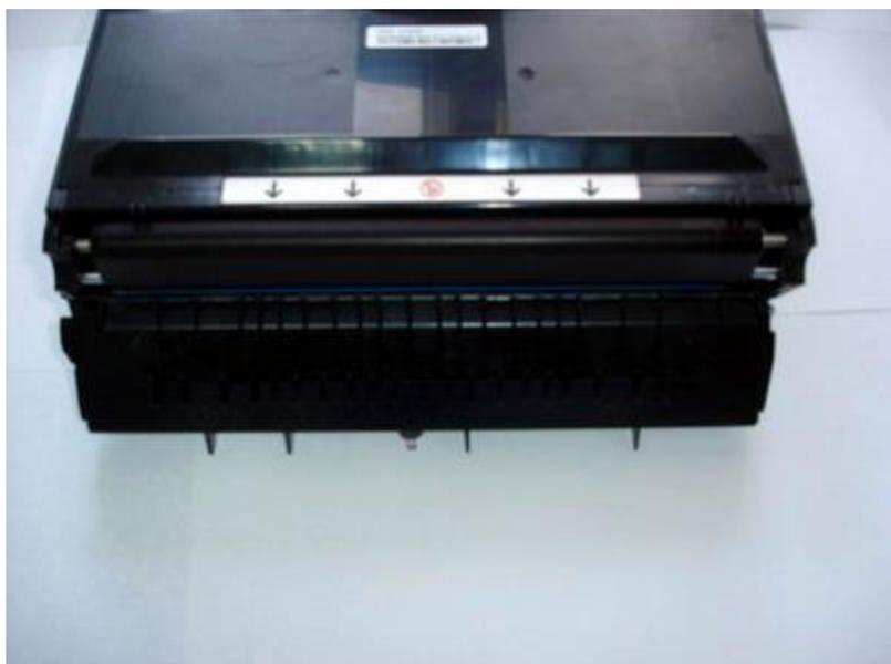
Отсек с отработанным тонером закрыт крышкой на двух болтах.
