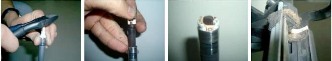
13) Надеть на ось магнитного вала: распорную втулку, шестерню привода и боковой стабилизатор.
