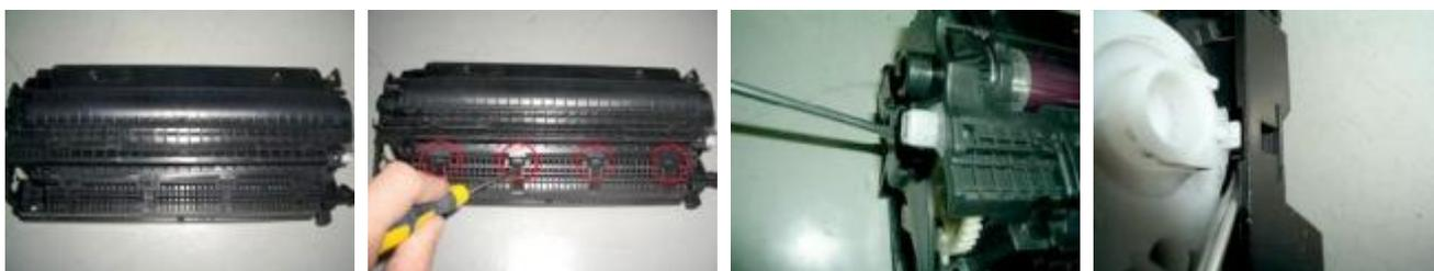
2) Для разборки картриджа необходимо завернуть шторку фотобарабана, либо снять ее (см. Рис. 5) это значительно облегчит работу.
