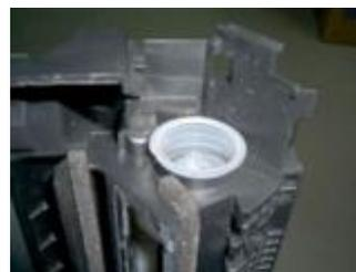
19) Заправьте тонер типа CANON E16 в количестве 150гр. (см. рис. 30) и закройте отсек пробкой бункера тонера (см. Рис. 31).
