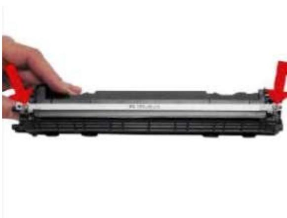
**Открутите два самореза и снимите дозирующее лезвие**
