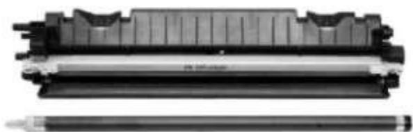
**Снимите магнитный вал с подшипниками скольжения (бушинги)**
