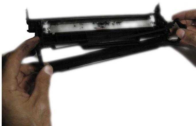
**21. Снимаем пружинку шторки, запоминая как она была расположена.**
