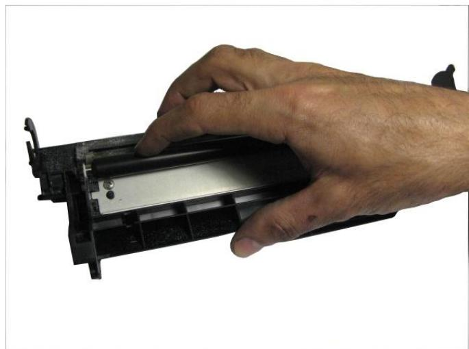
**37. Наносим старт-пудру на уплотняющее лезвие и лезвие очистки.**
