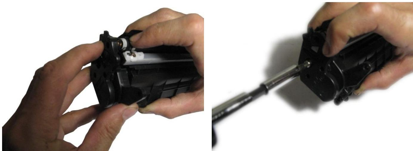
61. Аккуратно устанавливаем крышку следя за тем, чтобы срез на магнитной втулке совпал со срезом в крышке.
