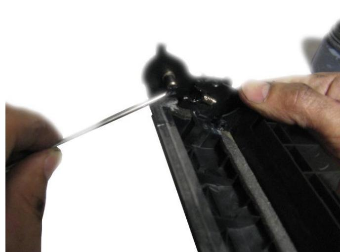
**33. Наносим токопроводящую смазку на контактный держатель вала первичного заряда.**
