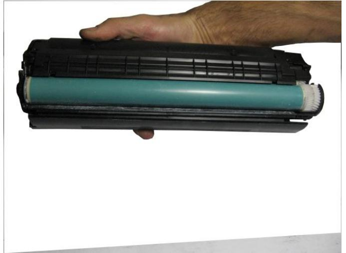
65. Придерживая с одной стороны пружинку - соединяем две половины картриджа и одеваем второе ушко пружинки.
