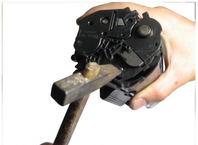
**67. Устанавливаем металлическую втулку с одной стороны.**
