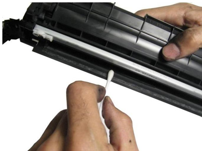
**51. При помощи специальной насадки для тонерного пылесоса очищаем бункер от тонера внутри.**
