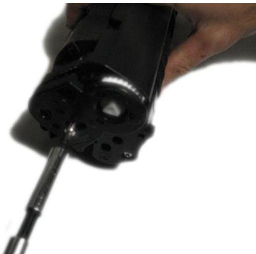
**69. Устанавливаем крышку, при этом прижимая фотобарабан.**
