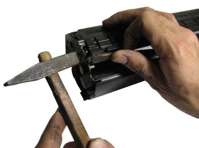
**13. Используя довольно длинную металлическую шпильку добираемся до фиксирующей обе половины картриджа металлической втулки с внутренней стороны.**
