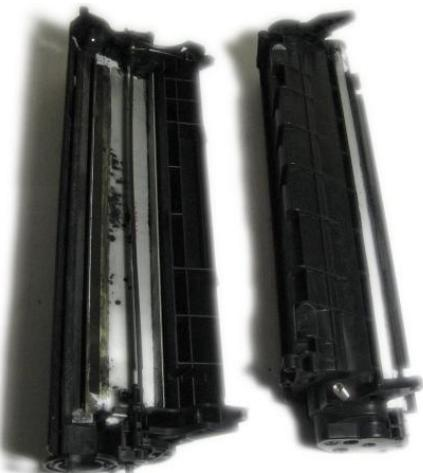
**19. Придерживая пальцем пружинку рассоединяем картридж на две половины.**
