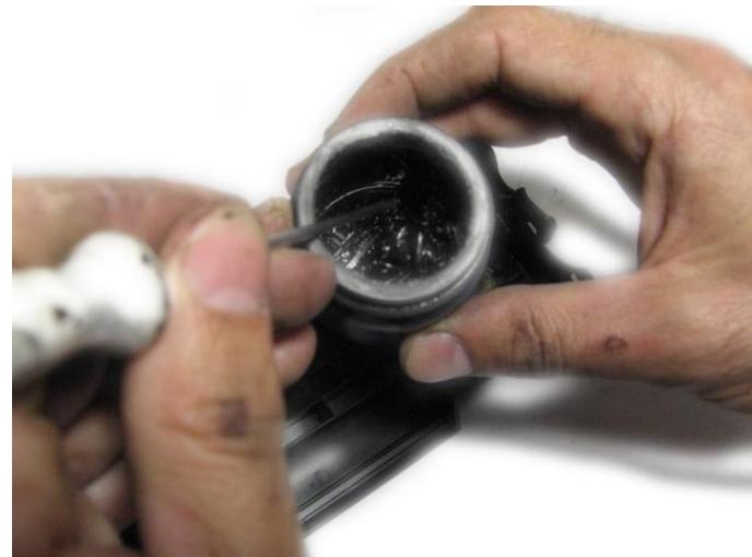
**31. Удаляем старую токопроводящую смазку с контактного держателя вала первичного заряда.**
