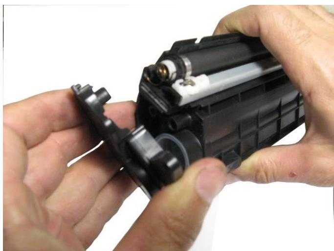
**45. Извлекаем саморез с противоположной стороны от блока шестеренок.**
