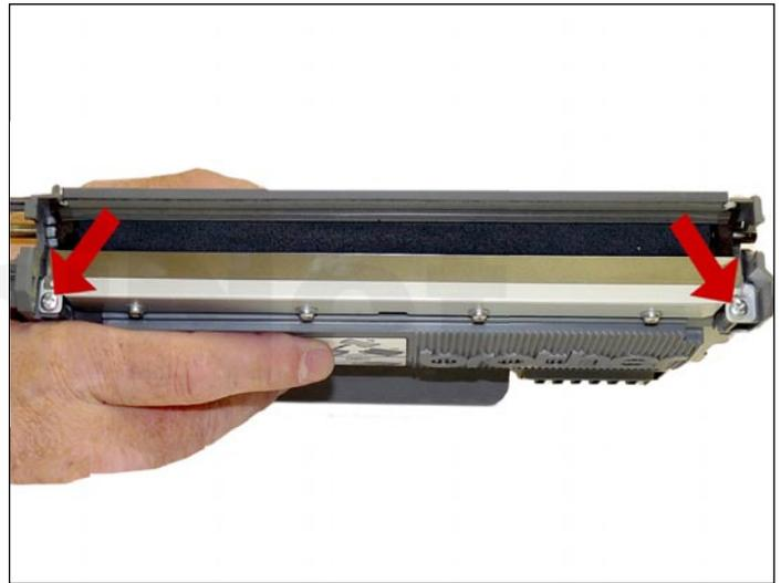
14. Limpie cuidadosamente la cuchilla dosificadora prestando atención en no doblarla. Instale la cuchilla nuevamente con sus dos tornillos.
