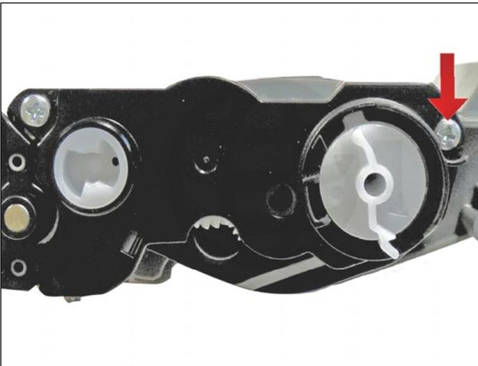
4. En el lado de la tapa izquierda saque los dos tornillos y el lateral.
