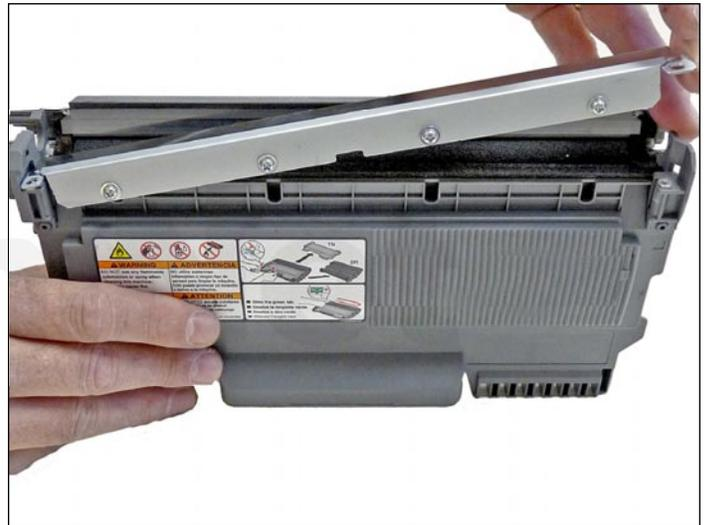
11. Remueva los dos tornillos de la cuchilla dosificadora y también la cuchilla. A diferencia de otros modelos de cartuchos este no tienen la cuchilla pagada a los sellos, así que puede ser retirada para ser limpiada.
