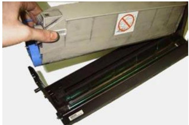
Снимаем тубу, высыпаем отработку, отжав клапан. Засыпаем тонер через пробку
