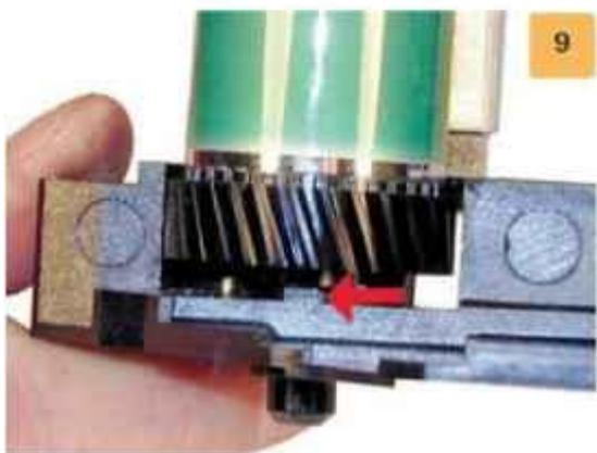
Снимите барабан. Смотрите Рисунок 10.
