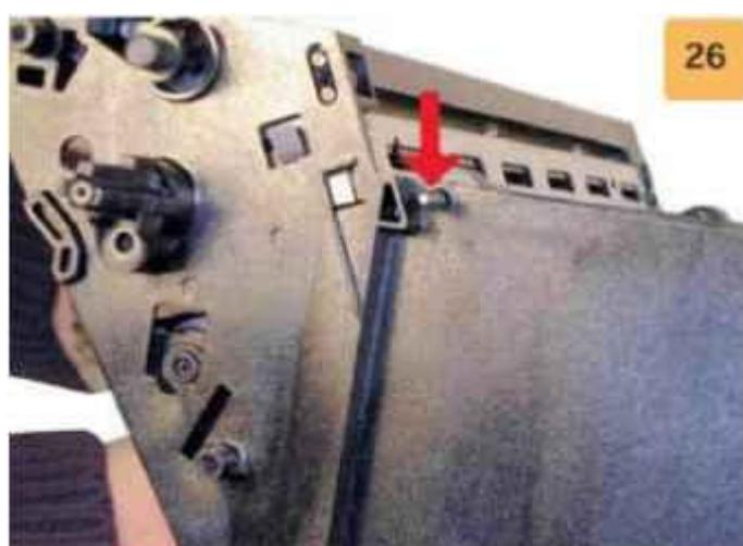
Снимите большой осевой штифт. Закрутите четыре болта на камере мусоросборника (два или три из них будут Torx типа). Смотрите Рисунок 30.
