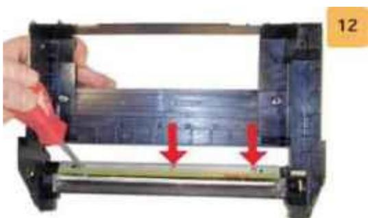
Снимите сливную заглушку с устройства подачи тонера и вытряхните тонер. Или при помощи вакуумного вычистите его. Зажмите заглушку в центре, чтобы ее не повредить.
