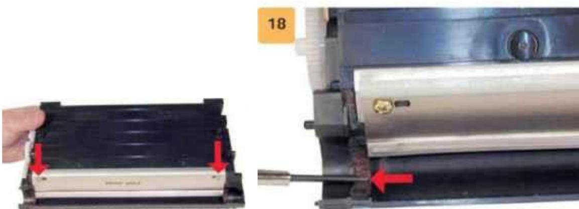
Установите Лезвие Дозирования и закрутите два болта. Смотрите Рисунок 19.
