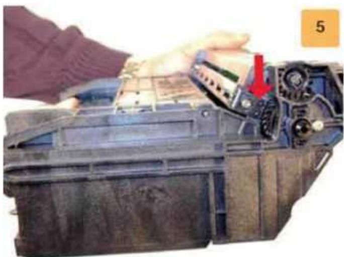
На каждой стороне картриджа имеется по одному шарнирному болту. Выталкивайте их при помощи небольшого пробойника или отвертки до тех пор, пока они не выскочат. Снимите камеру подачи и два штифта. Смотрите Рисунки 6 и 7.
