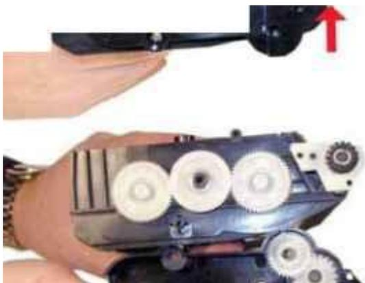
Открутите два винта и снимите лезвие дозирования. Вычистите остатки тонера из контейнера. При помощи отвертки "распушите" фетровый уплотнитель, немного поскоблив по нему. Смотрите Рисунки 17 и 18.
