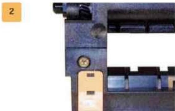
С правой стороны картриджа открутите пять болтов. Два или три из них могут быть Torx типа. Снимите камеру мусоросборника. Большой осевой штифт барабана отсоединится вместе с камерой. Поместите ее обратно, так чтобы не повредить барабан. Смотрите Рисунок 3.
