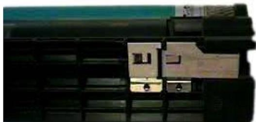
Под пластинами (фото) находится предохранитель: 0,125 А. При замене, принтер определит как новый фоторецептор. Также можно сделать более быстрый вариант, вставляете жучек, запускаете принтер, проходите первый запуск, выключаете принтер, снимаете жучек.
